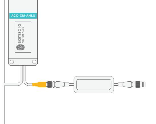
**EN** Ensure isolator is securely attached to ACC-CM-ANLG.**FR** Veillez à ce que l'isolateur soit fixé en toute sécurité sur ACC-CM-ANLG.**DE** Vergewissern Sie sich, dass der Isolator sicher am ACC-CM-ANLG angebracht ist.**ES** Asegúrese de que el aislador esté conectado firmemente al ACC-CM-ANLG**IT** Accertarsi che l'isolatore sia ben fissato all'ACC-CM-ANLG.**NL** Zorg ervoor dat de isolator goed is bevestigd aan de ACC-CM-ANLG.
